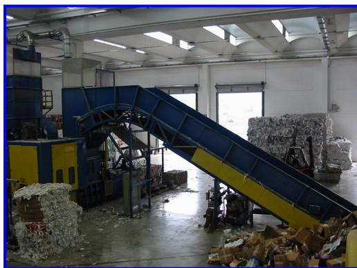
**Foto 4.3 - Impianto di adeguamento volumetrico**
